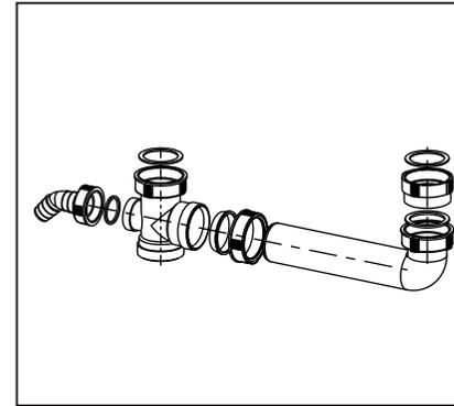
**Ablaufverbindung mit exentrischem Abgang und Höhenausgleichsstück**
