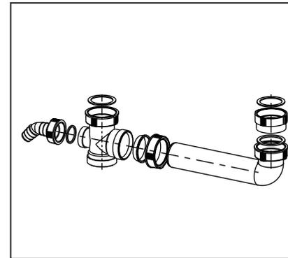
**Ablaufverbindung mit exentrischem Abgang und Höhenausgleichsstück**
