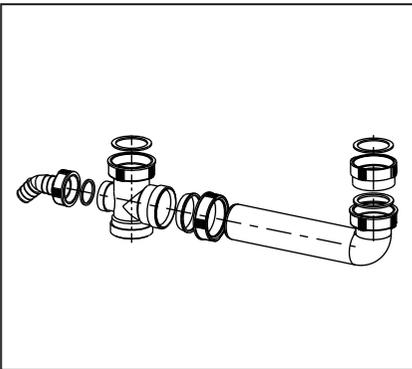
**Ablaufverbindung mit exentrischem Abgang und Höhenausgleichsstück**
